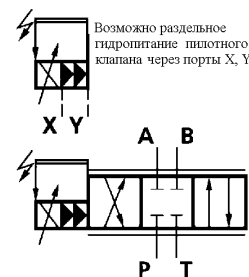
Исполнение с 4-я рабочими портами 3-х каскадный клапан
